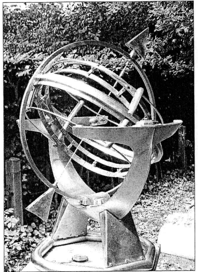
Fig. 7. Armillairsfeer met draaibaar zodiakaal ringenstelsel. Ontwerp en uitvoering: Eugène Roebroek en Wiebe Westra (Haren Gr., NL).
